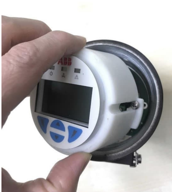
— 图3.4: 拔出并卸下触摸键/LCD组件
